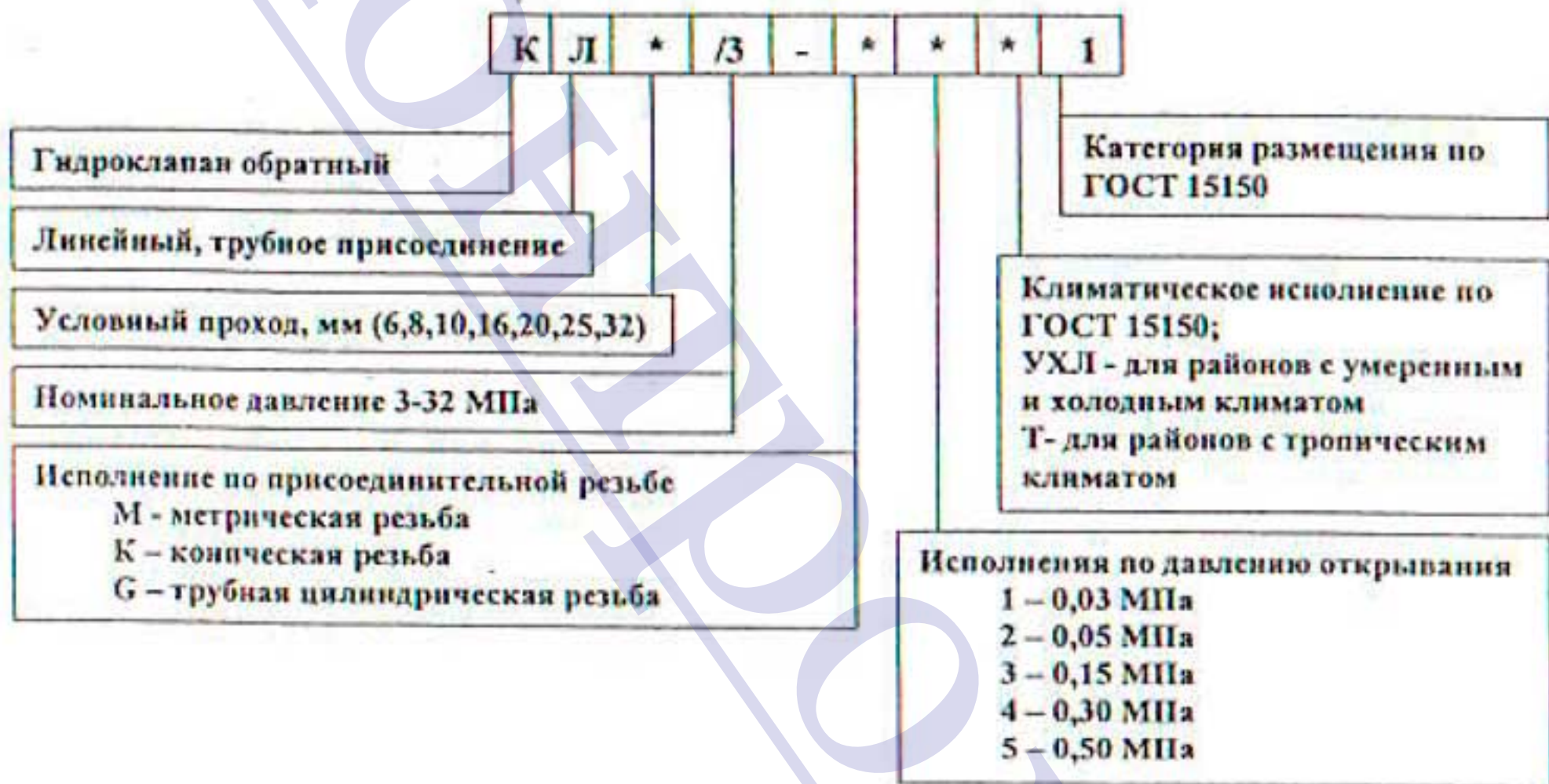
Рисунок 1- структура условного обозначения
