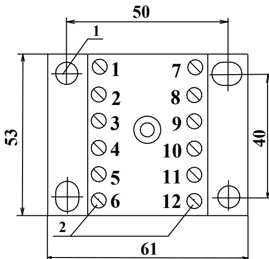
1 -Четыре отверстия для крепления колодок КР-6, КР-4Т;
