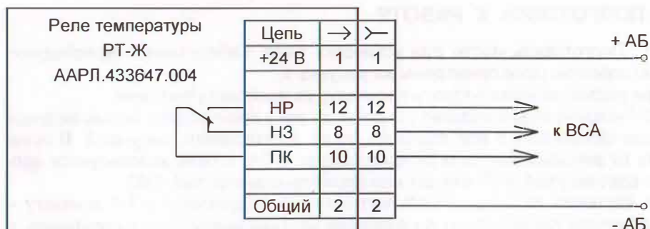
Рисунок 2 - Схема подключения РТ-Ж ААРЛ.433647.004.
