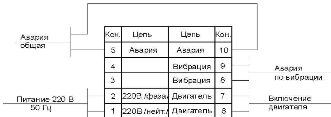
Рис.1 Схема внешних подключений блока
