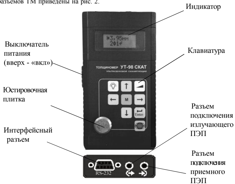
Рис.2 Расположение органов управления и индикаторов толщиномера
