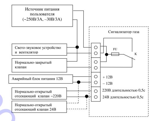
Рисунок 2. Схема подключения сигнализатора «Страж»: 110М; 111М; 110УМ; 111УМ; 110УМ-005; 111УМ-005 к нормально-открытому импульсному клапану 24В, нормально-открытому импульсному клапану 220В (типа EVG/NA, EVRM-NA, M16/RM-NA и др.), свето-звуковому прибору, нормально-закрытому клапану с потенциальным или импульсным управлением
